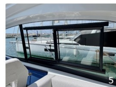
(1) Système de mise à l'eau de l'annexe (treuil et rouleaux) (2) Réfrigérateur de cockpit 49 L (3) Pack Audio Fusion : Fusion RA210 + 2 Enceintes (4) Écran multifonctions Garmin 12" (5) Fenêtres coulissantes bâbord et tribord (1) Tender launching system (winch and rollers) (2) 49 L Cockpit refrigerator (3) Audio Pack Fusion: Fusion RA210 + 2 Speakers (4) Garmin 12" Multifunction screen (5) Port and starboard sliding windows
