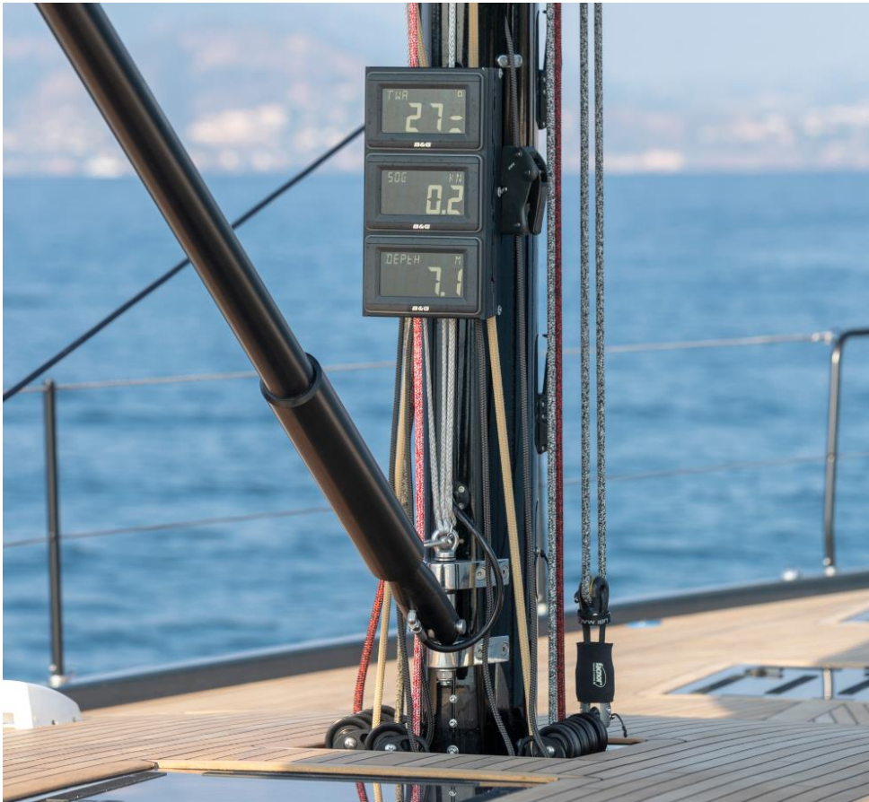
20/20HV mast displays + H50 wireless handset + AIS-500 transponder Afficheurs pied de mât 20/20HV+ Afficheurs pied de mât 20/20HV + transpondeur AIS-500
