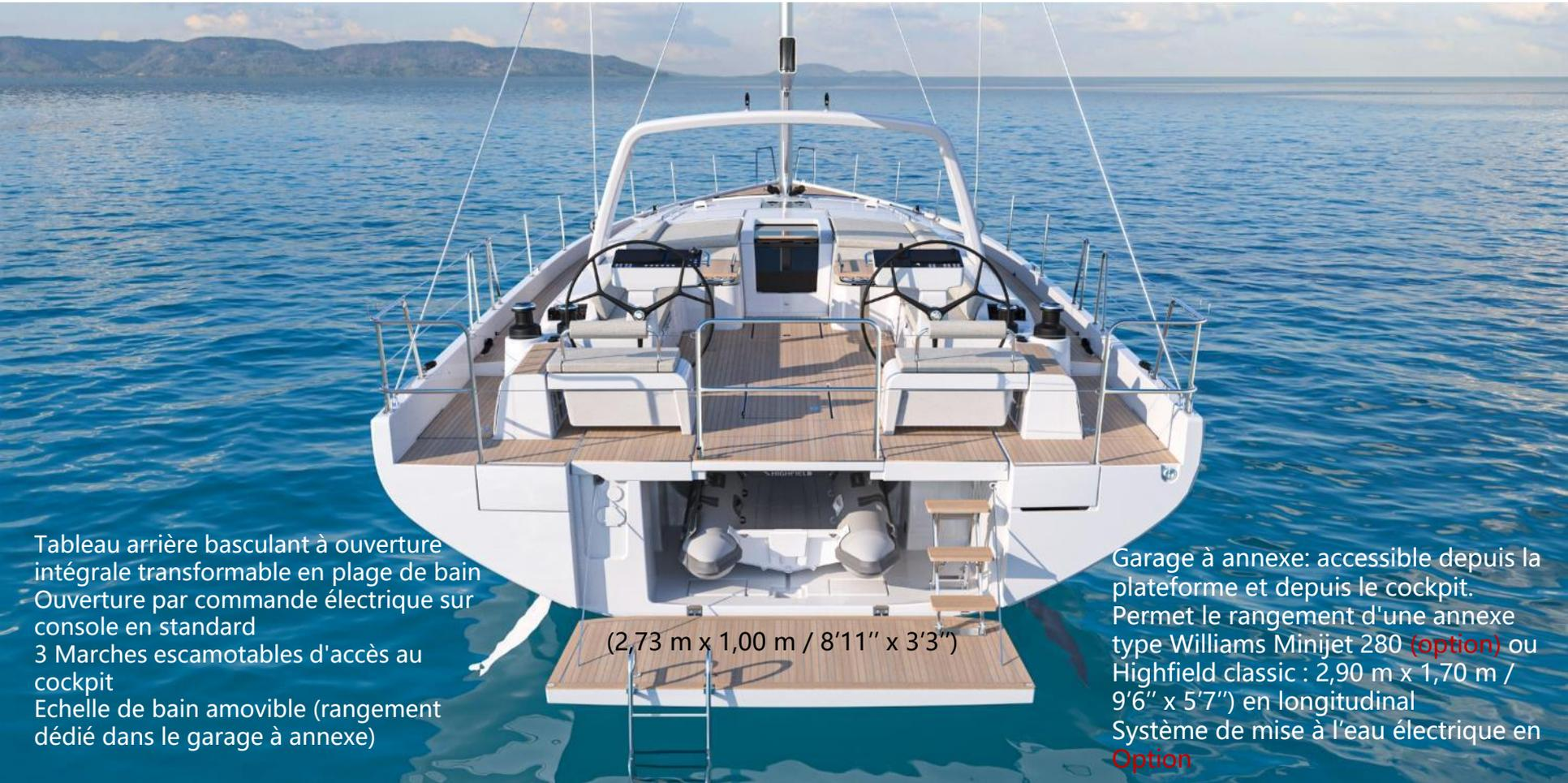
Tableau arrière basculant à ouverture intégrale transformable en plage de bain
